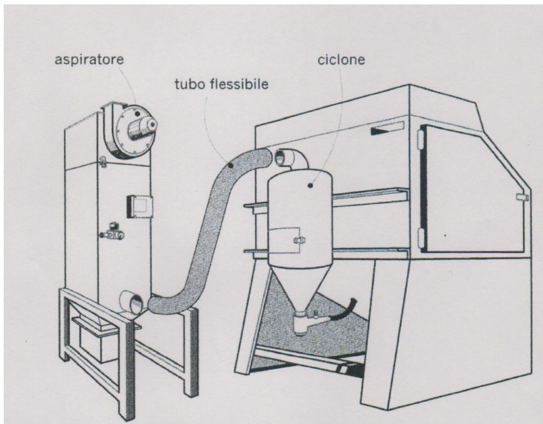
Questi filtri sono realizzati espressamente per lavorare con sabbiatrici e pallinatrici manuali di tipo "a depressione". La filtrazione dell'aria è fatta tramite speciali cartucce filtranti in poliestere, meccanicamente molto resistenti e, all'occorrenza, anche lavabili.
